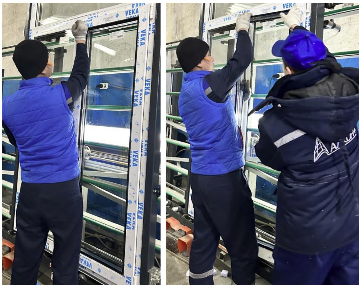
Рисунок 12 – Снятие и установка стеклопакета
