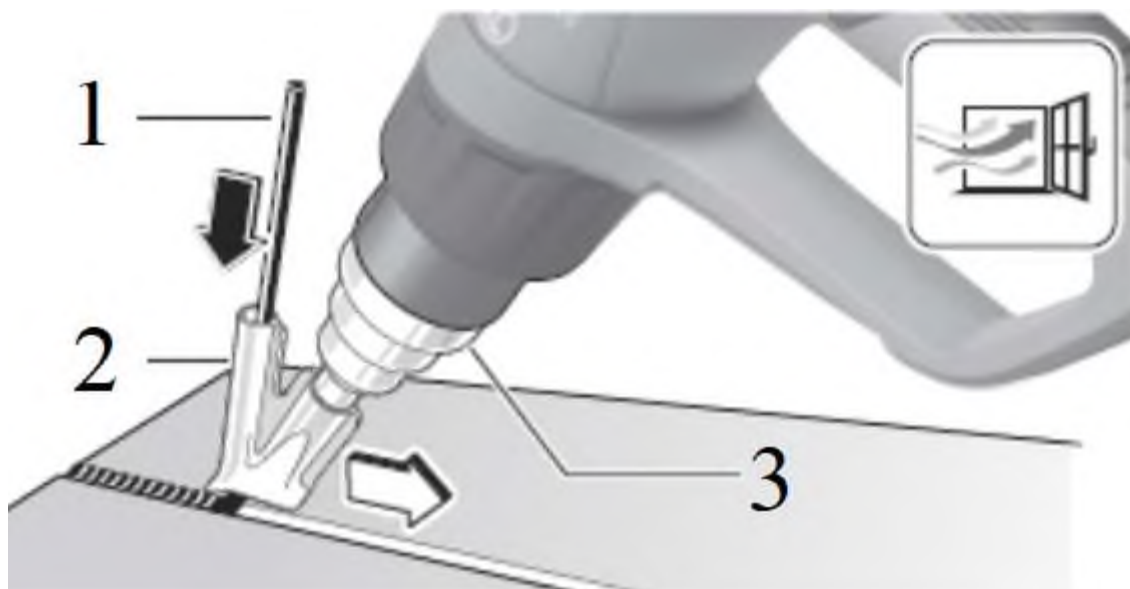
17-сурет – Линолеум түйістерін дәнекерлеу
