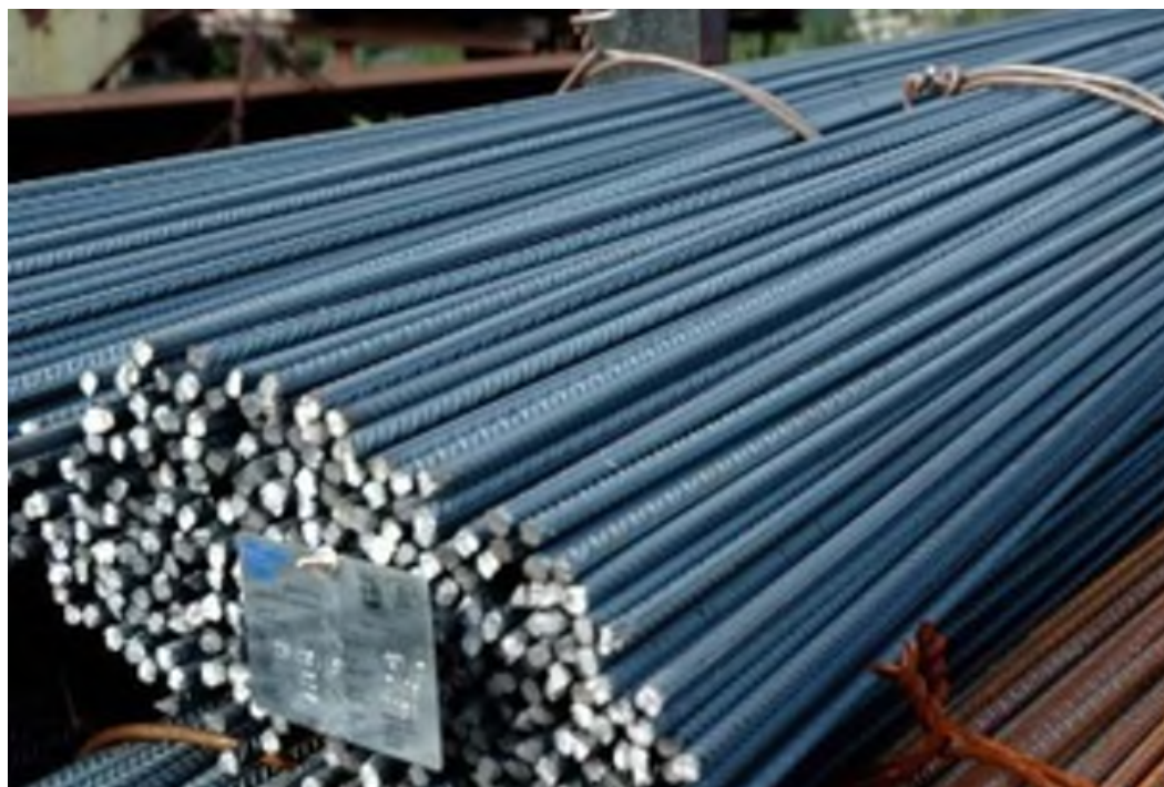
1-сурет - Мерзімді профильді арматуралық өзектердің жалпы көрінісі
