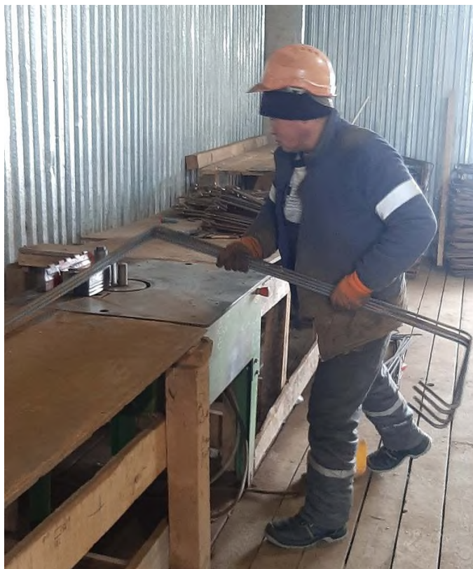
5-сурет - Жетек станогындағы арматураларды ию
