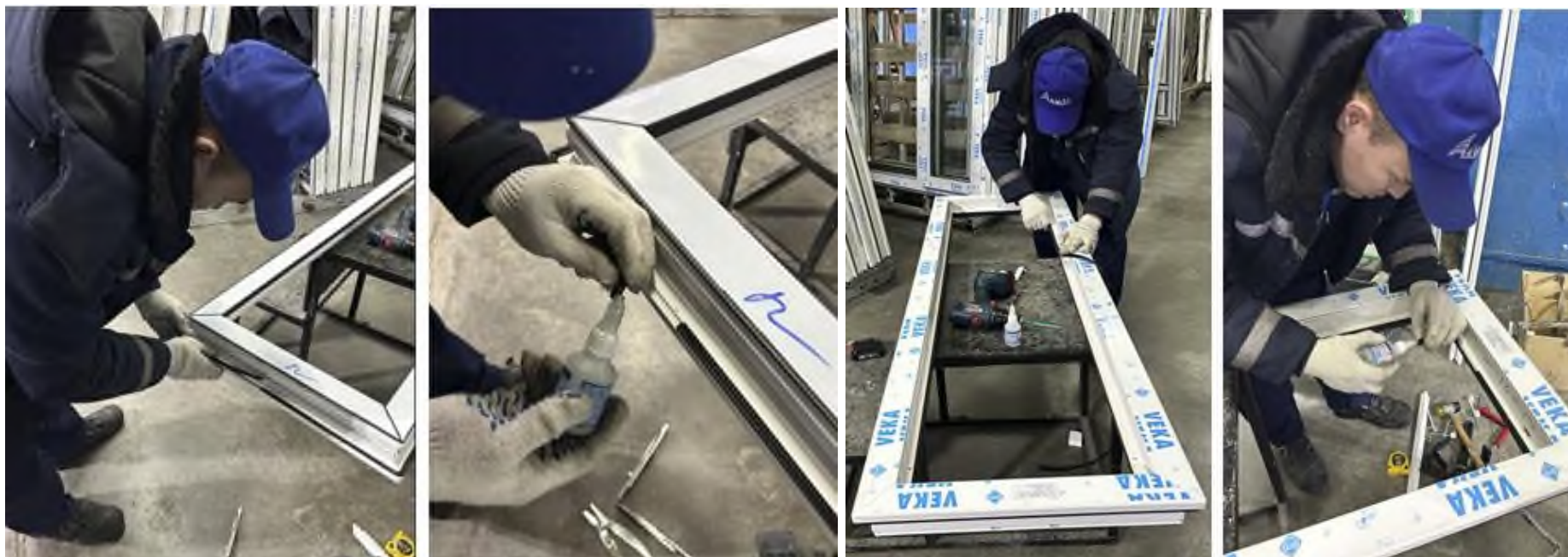
Рисунок 13 – Замена уплотнителя
